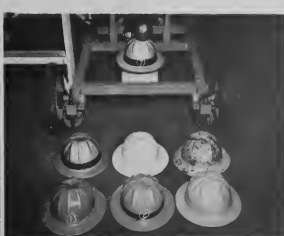
THE BALL, about to strike a damaged safety hat atop a wooden model of a man's head, broke worn and used head band — harness sets. E BALU, cerca di dal e sombrero di seguridad, a kibra e esero di parti paden di e sombrero, cu tabata usá y poco kuita.
